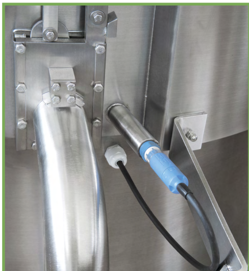
Wbudowany czujnik pH do atomatycznego pomiaru kwasowości zakwasu i podmłody
