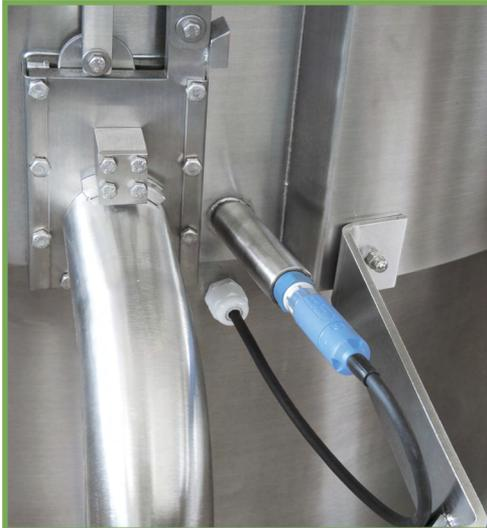
*Eingebauter pH-Fühler zur automatischen Messung der Säure von Sauerteig und Vorteig*
