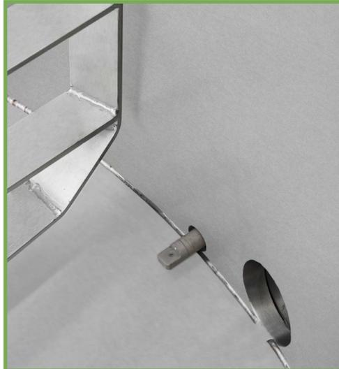
*Innenansicht des neuen Hematronic pH-Fermenters mit pH-Fühler und angepasstem Rührwerk*
