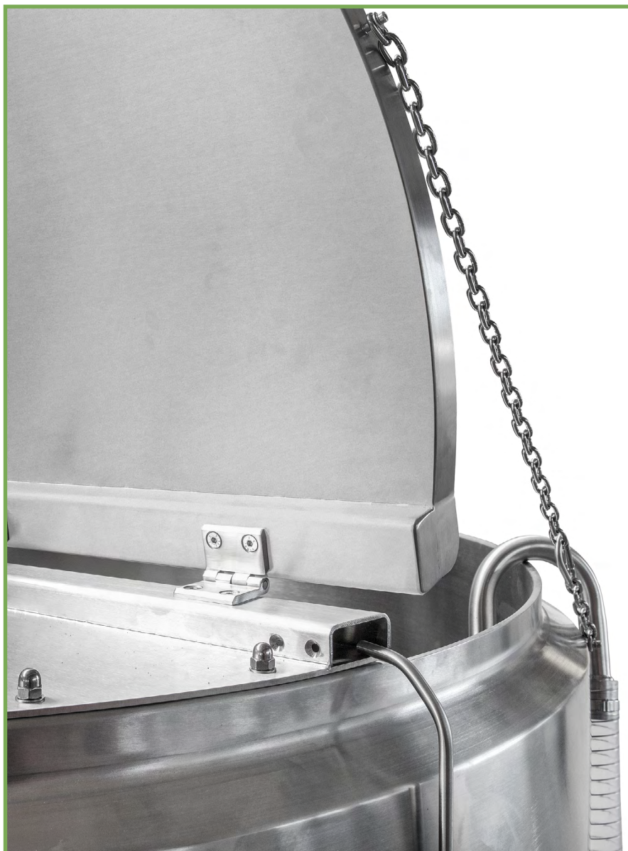
Nové vymezovací řetízky k potřebnému zajištění jak dalece má být otevřené víko výrobníku při plnění výrobníku surovinami
